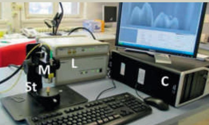
**Abbildung 1:** OCT-Geräteaufbau der „Swept Source OCT“: Lasergenerator (L), flexibler Messkopf (M), Stativ (St), Computer mit der OCT-Software (C)
