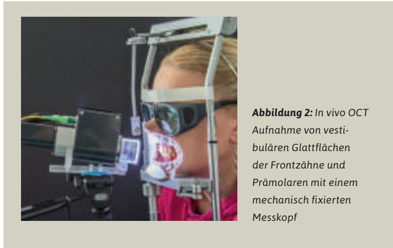
**Abbildung 2:** In vivo OCT Aufnahme von vestibulären Glattflächen der Frontzähne und Prämolaren mit einem mechanisch fixierten Messkopf
