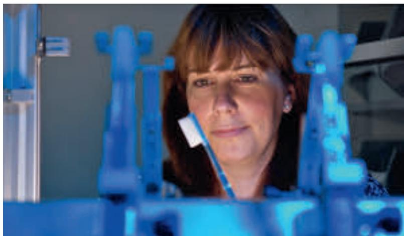
*Dr.-Ing. Sandra Sarembe arbeitet an einer Bürstmaschine zur Untersuchung der mechanischen Belastung von Zähnen durch Zahnpflegemittel. Foto: Fraunhofer IMWS*
