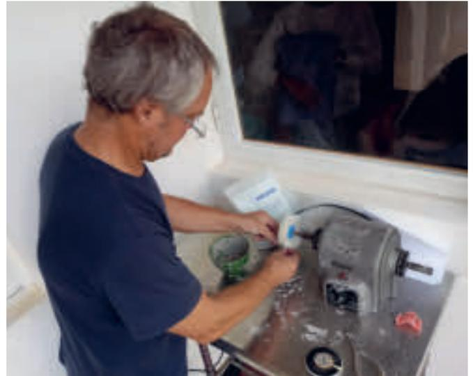
Zahntechniker Ralf Thum aus Halle (Saale) bearbeitet auf Haiti mit einer Schleifmaschine Prothesenrohlinge.
